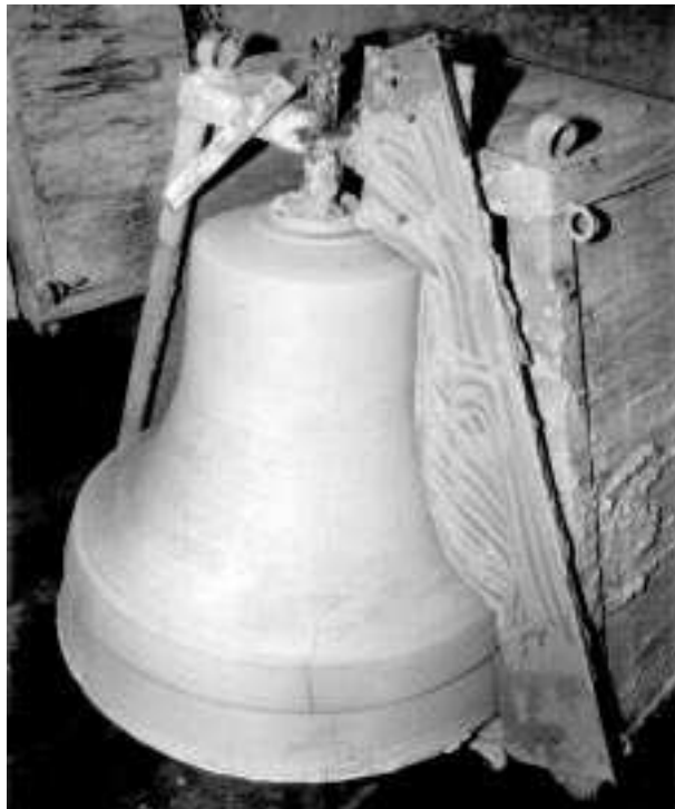
Vízszintes és függőleges helyzetű harangformázás Gombos Lajos őrbottyáni műhelyében (1999)
