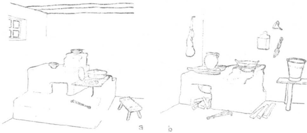
10. Tüzelők: a) tűzhely kemencével és fűtővel, Tr; b) katlan és fűtő, Bf.
