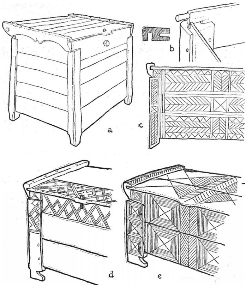
12. kép. Kar és részletrajzok. a) 20 vékás (1 véka — 16 kupa, kb. 30 l) gabona-tartó kar, hasított bükkfa deszkából; a hijuban (padláson) a közfal fölött vagy az ereszben állott; helyben készült, Bene Antal, Impér; b) a kar bal felső sarkának szerkezete; c) gúnyás szuszék (100—120 évvel ezelőtt a parafernum-levéiben is ilyen szerepelt menyasszonyi ládaként és a házban a fő helyen állott; részlet), Impér; d—e) gúnyás szuszék ok részletrajzai. Feltíz.
