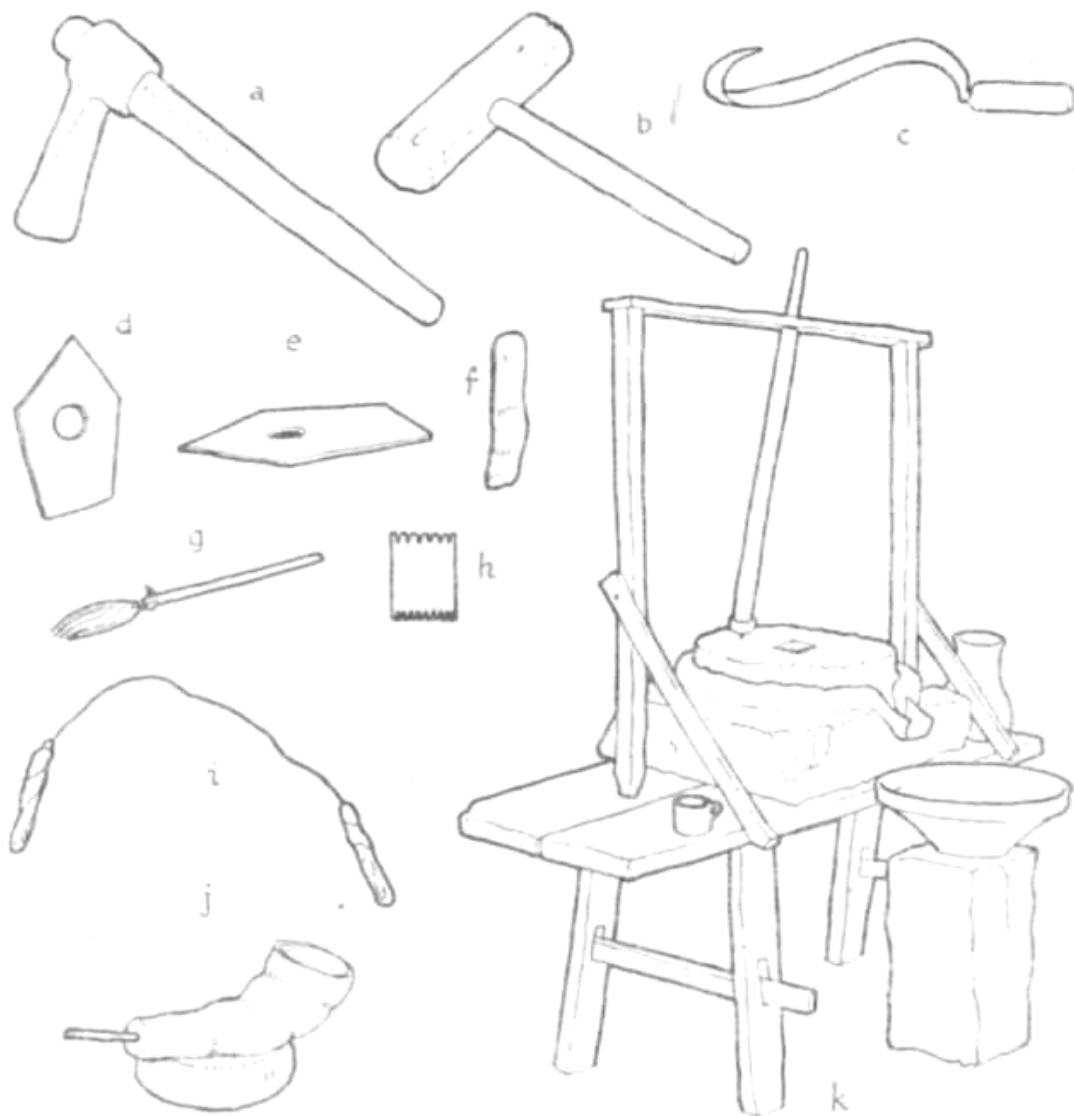
7. Fazekaseszközök, Gf: a) kázma (16 és 86 cm), b) födverő-bot (27 és 58 cm), c) födkasza sarlóból alakítva (28 + 13 cm), d-e) lapockák (15 és 20 cm), f) bőröző , g) meszelő (25 cm), h) író (vastag, fogazott bőrlap, 7,5 cm), i) szelődrot (24 cm), j) írószeru (17 cm), k) mázórló rezsnycse .
